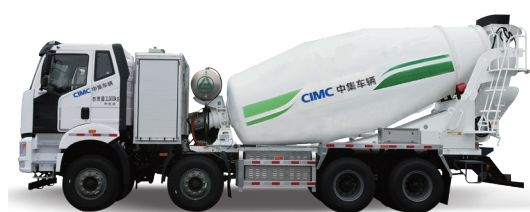
混凝土搅拌车 Concrete mixer truck
